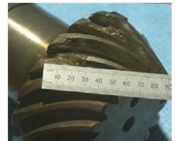
Beschädigte Zähne des Antriebskegelrads
